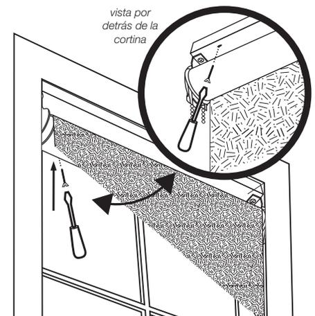
marco de la ventana (o acomódela en la posición deseada), asegurándose que la cortina queda centrada en la apertura de la ventana - luego presione hacia arriba en las cabezas de los tornillos dejando las impresiones de las puntas en la madera del marco de la ventana. Ahora use esas impresiones como guía y perfora orificios de montaje usando una broca de 5/64", luego atornille la cortina en su lugar.
