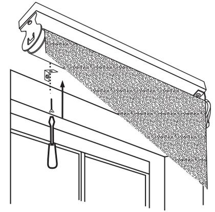
la persiana sobre la ventana – y marque el lugar de cada orificio en el riel. Perfore la tela en los lugares marcados usando la punta de un destornillador, luego perfore los orificios de montaje usando una broca de 5/64". Fije la persiana a los soportes usando los tornillos de 3/4" incluidos
