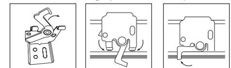
de manera que engancha el frente interno y posterior externo del riel, luego presione el brazo de aseguramiento hacia adentro para fijarlo en su sitio.
