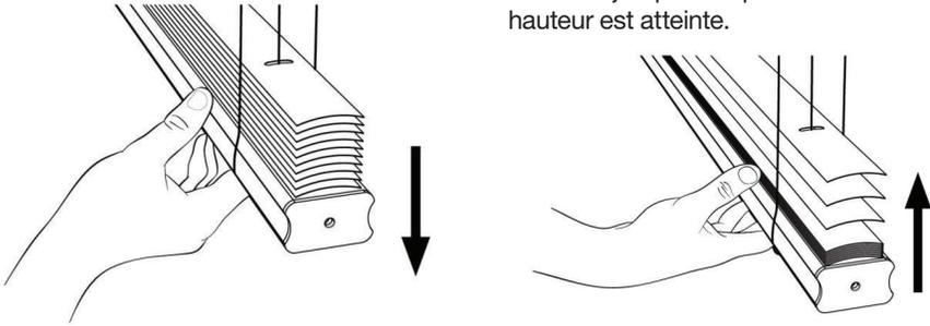
**Pour incliner les lattes:** Faites pivoter la baguette pour atteindre position souhaitée des lattes.
