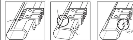
**Pour le style «B»** [voir l'illustration ci-dessous] soulevez le rail de tête en position telle que le le bord avant du support est sous le bord avant intérieur du rail de tête, et puis poussez le rail de tête vers le haut jusqu'à la languette flexible au bas de chaque le support s'enclenche à l'arrière de la tête rail.
